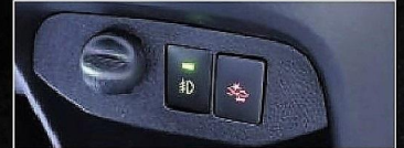
▲スイッチは純正の空きホールを使用
